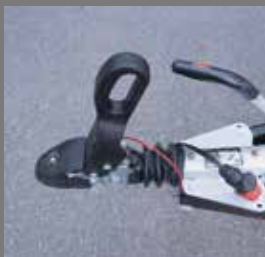
Sicherheitskupplung mit Spurstabilisierung
