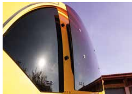
Die getönten und 5-fach verstellbaren Ausstellfenster sorgen für die optimale Luftzufuhr.
