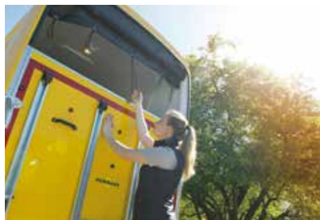
Das exklusive Humbaur Windschott bietet eine zugfreie Belüftung und eine kontinuierliche Luftzirkulation.
