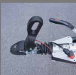
Sicherheitskupplung mit Spurstabilisierung
