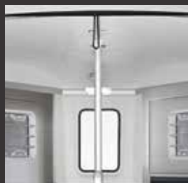
Mittelpfostentrennwand (für Notos Modelle optional erhältlich)
