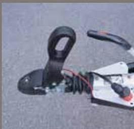
Sicherheitskupplung mit Spurstabilisierung
