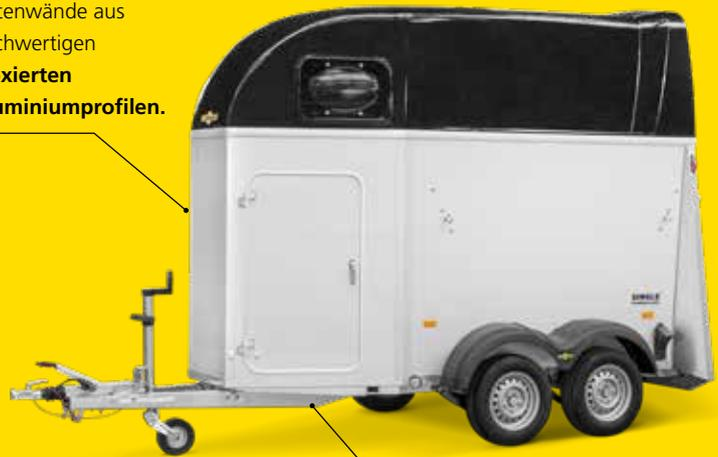
**Geschweißtes Fahrgestell**, im Tauchbad feuerverzinkt und mit einer geschraubten V-Zugdeichsel ausgestattet.
