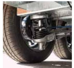
Das EquiDrive® PLUS S Schraubenfederfahrwerk
