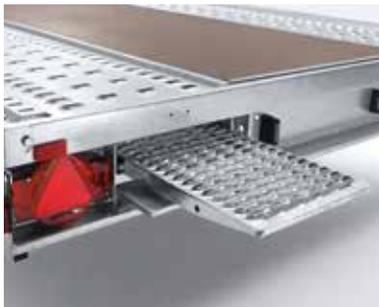
Im Bohlenschacht einschiebbare feuerverzinkte Stahlbohlen
