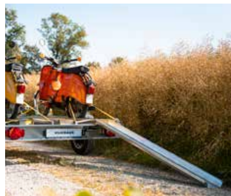
1 Auffahrschiene im Bohlenschacht integriert
