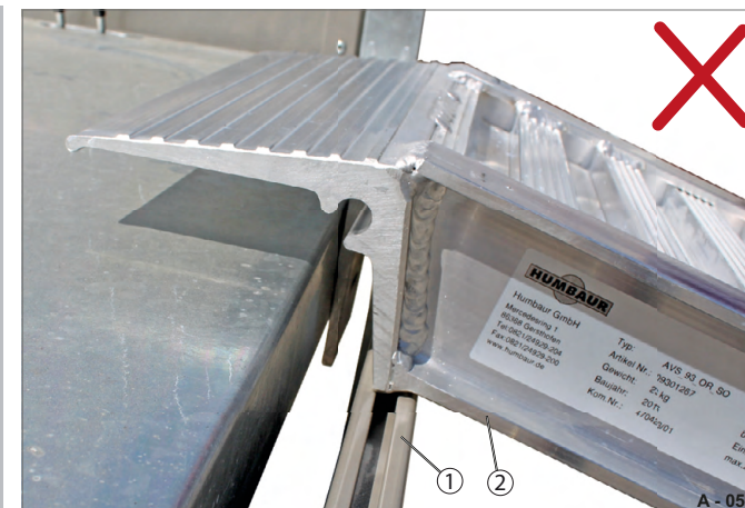
Abb. 97 Auffahrbohle falsch aufgesetzt
