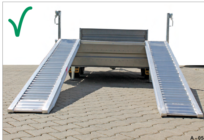
Abb. 99 Spurweite richtig eingestellt
