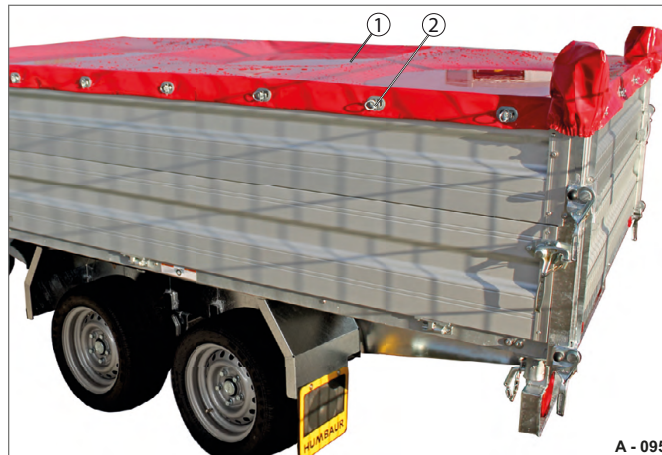
Abb. 72 Beispiel: Flachplane bei Bordwand-Aufsatz
