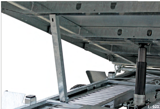
Abb. 25 Wartungsstütze als Ladebrücken-Sicherung
