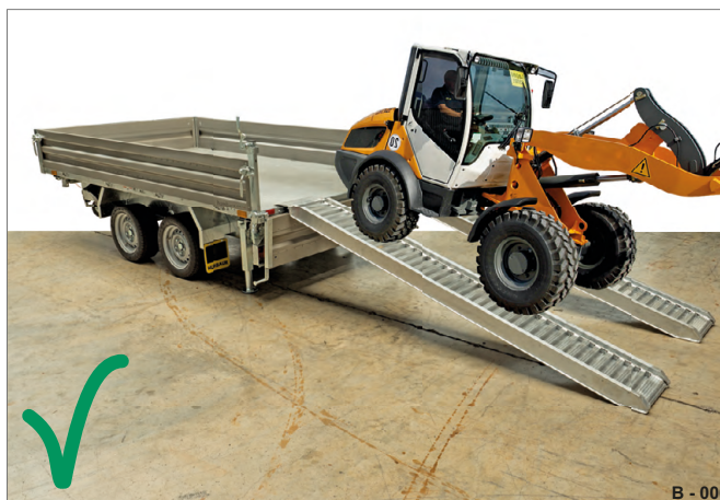
Abb. 3 Befahren des Anhängers
