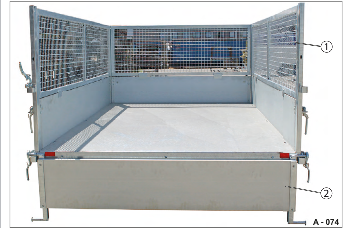
Abb. 58 Heckseitiger Stahlgitter-Aufsatz demontiert
