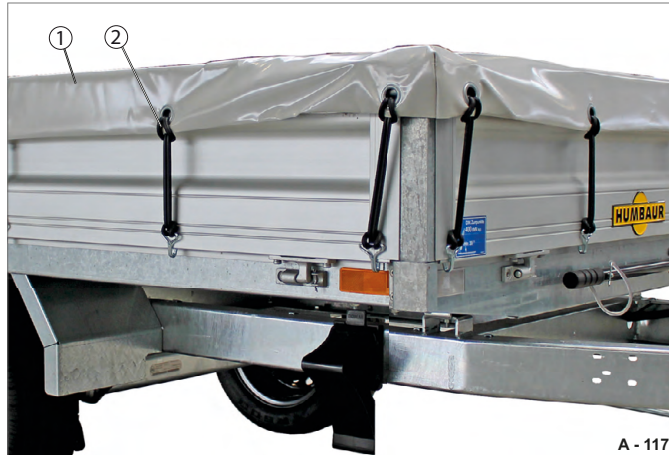
Abb. 70 Beispiel: Flachplane bei Grund-Bordwand
