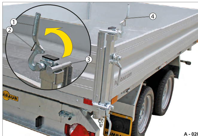
Abb. 18 Heck-Bordwand oben entriegeln
