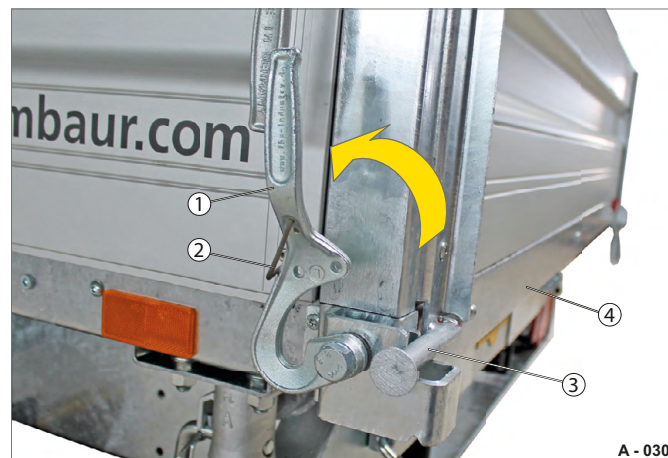
Abb. 21 Heck-Bordwand unten entriegelt
