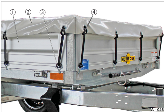
Abb. 53 Beispiel: Flachplane, Grundbordwand
