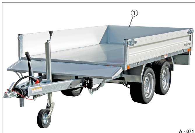
Abb. 18 Durchladefunktion: Heckbordwand, geschlossen
