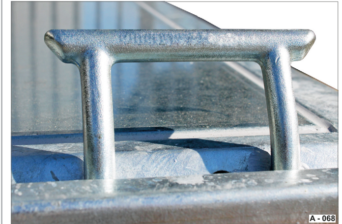
Abb. 76 Zurrbügel, optional, 800 daN (kg)
