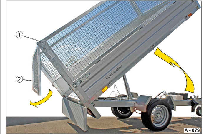
Abb. 47 Pendelbetrieb des Stahlgitteraufsatzes
