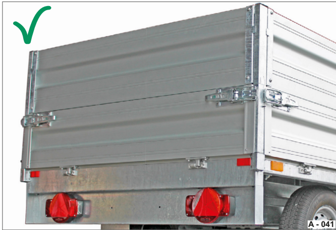
Abb. 42 Heckbordwand / Bordwandaufsatz, Fahrstellung
