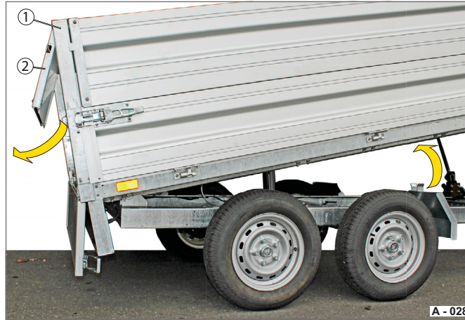
Abb. 46 Pendelbetrieb des Bordwandaufsatzes
