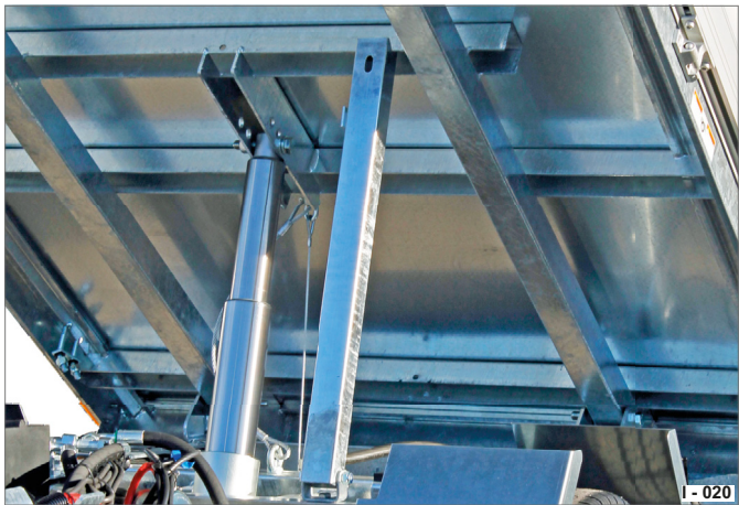
Abb. 21 Wartungsstütze als Ladebrückensicherung
