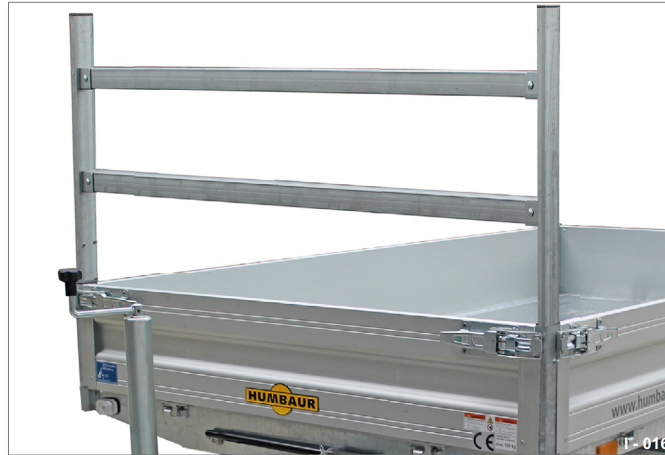
Abb. 17 An Stirnbordwand, in Eckrungen gesichert
