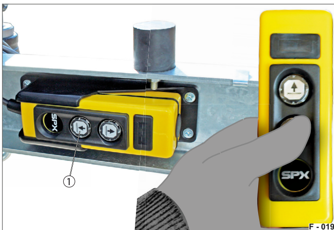
Abb. 24 Absenken mit Elektro-Hydraulik-Pumpe
