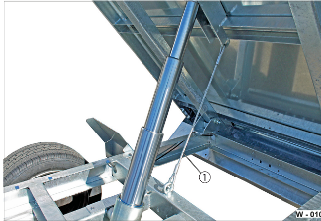
Abb. 13 Sicherungsmechanik, manuelle Hydraulikanlage
