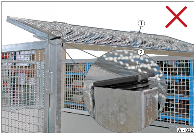
Abb. 48 Stahlgitteraufsatzwand umgeschwenkt, Negativbeispiel
