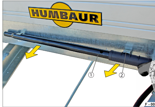
Abb. 2 Pumpenhebel entnehmen am Klemmhalter
