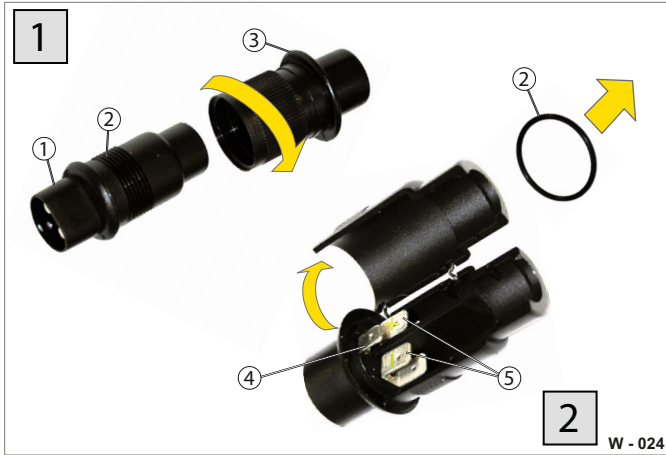
Abb. 28 Kabel an Batterieladestecker anschließen
